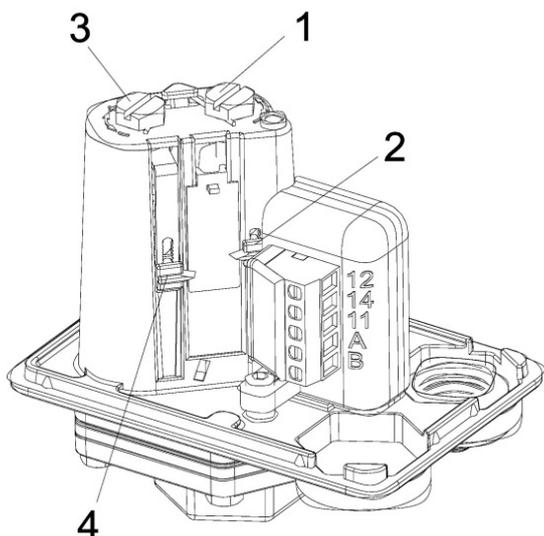
ю регулировочного винта (1) настройте верхнее значение переключения P1. Индикация с помощью красного индикатора (2). С помощью регулировочного винта (3) настройте нижнее значение переключения P2. Индикация с помощью зеленого индикатора (4). Шкала настройки не градуирована. Для точной настройки используйте манометр.
