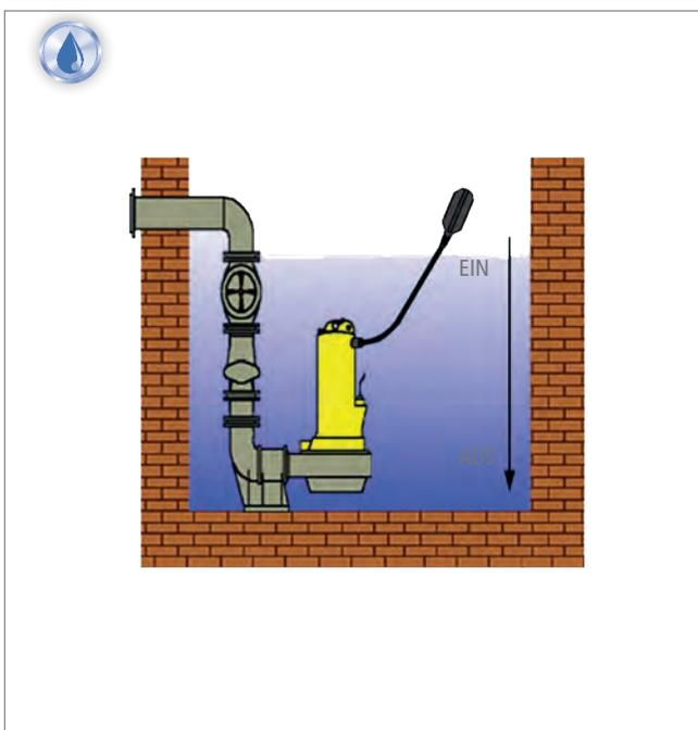
Bei diesem Verfahren werden Schaltkontakte in einem Schwimmkörper in Abhängigkeit des Neigungswinkels geschlossen oder geöffnet.
