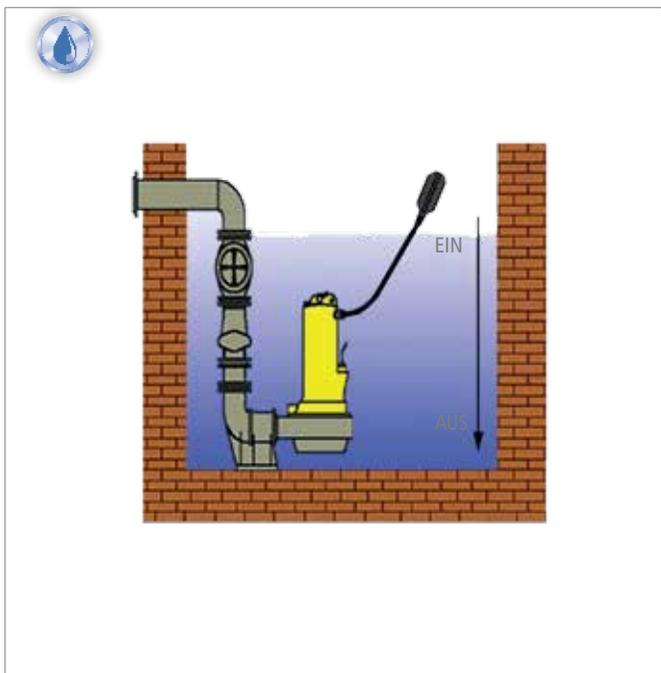
Bei diesem Verfahren werden Schaltkontakte in einem Schwimmkörper in Abhängigkeit des Neigungswinkels geschlossen oder geöffnet.
