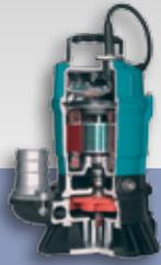
Dringt Wasser durch die Gleitringdichtung in die Ölkammer des Motors wird das Öl leitend. Fließt nun ein Strom zwischen der in der Ölkammer angebrachte Feuchtigkeitssonde und dem geerdetem Motorgehäuse, wird dies durch ein Relais erkannt und ausgewertet.
