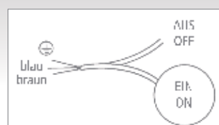
Schwimmschalter PSN-F zum Vollpumpen
