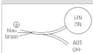
Schwimmschalter PSN-O zum Leerpumpen
